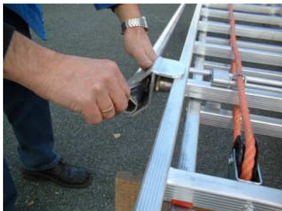
Bild 1 – Montage Beschläge an Gewindebolzen
